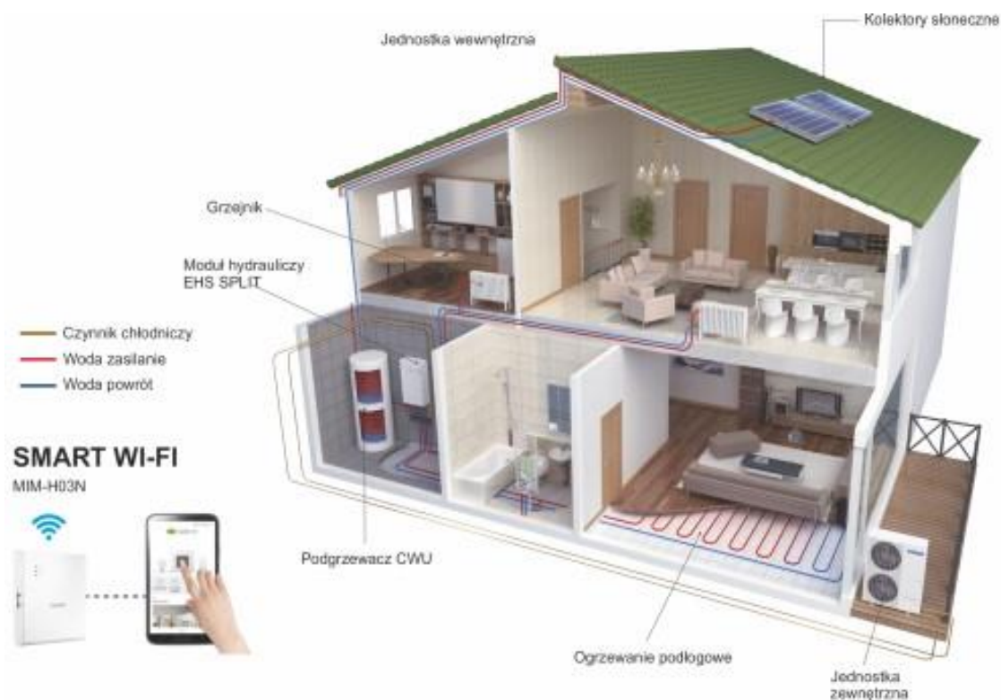
Rys. 3.6 Przykładowa instalacja wykorzystująca powietrzną pompę ciepła
